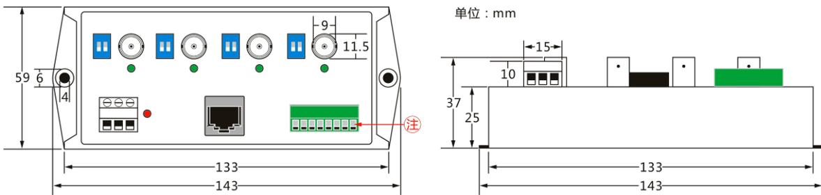
注: 此接线孔为螺丝压接固定, 建议容纳  $> 0.18\text{mm}^2 < 1\text{mm}^2$  的线缆。
